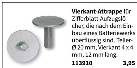
**Vierkant-Attrappe** für Zifferblatt-Aufzugslöcher, die nach dem Einbau eines Batteriewerks überflüssig sind. Teller- $\varnothing$  20 mm, Vierkant 4 x 4 mm, 12 mm lang.
