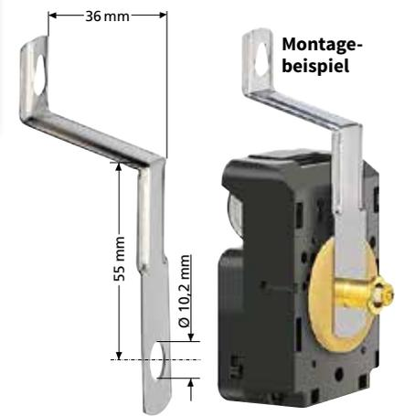
**Aufhänger** für sehr schwere Uherschilder oder Zifferblätter, z. B. aus Stein, bei Verwendung von Batterie- oder Synchronuhrwerken mit Ø 10,2-mm-Zentralbefestigung. Wird zwischen Uherschild und -werk montiert – das Gewicht der Uhr wird dann voll vom Aufhänger getragen. Geprägter, vernickelter Stahl.
